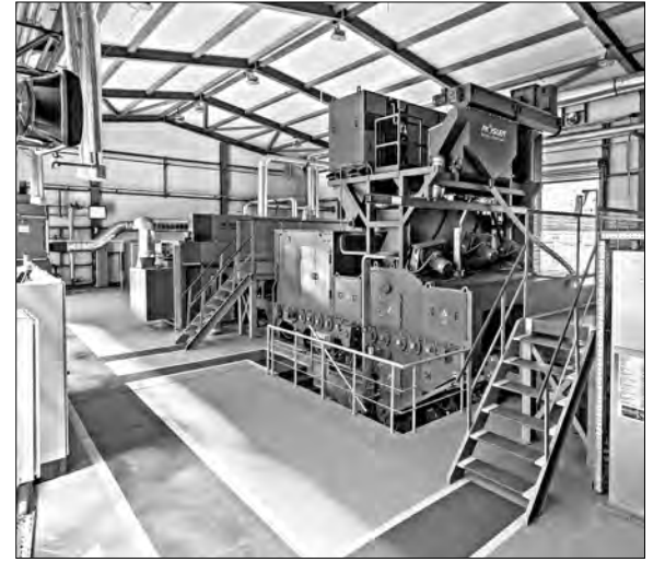
Автоматическая линия очистки и грунтовки металлопроката с современным немецким оборудованием
